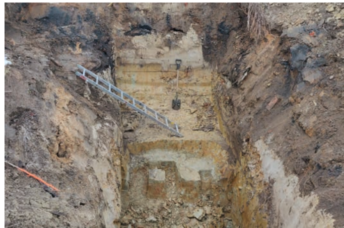
Rys. 7. Pobór blokowych próbek gruntu z dna wykopu badawczego [3]
