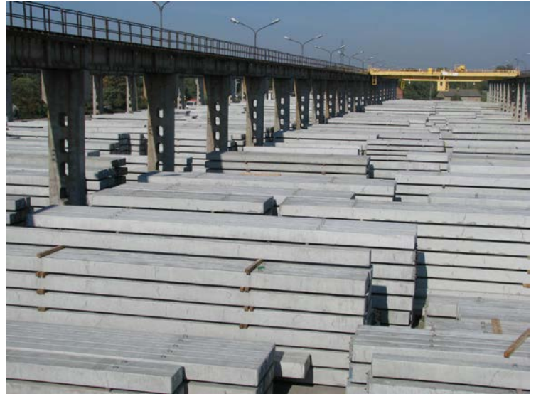
Fot. 8. Magazyn prefabrykatów pali
