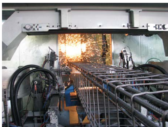
Fot. 2. Wykonanie zbrojenia z użyciem nowoczesnego automatu zbrojarskiego
