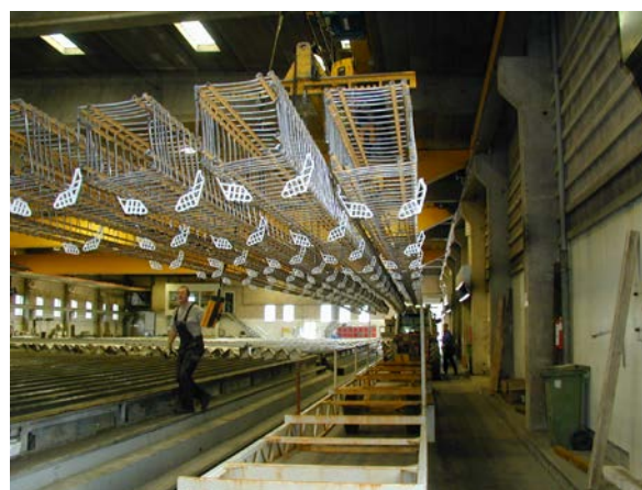
Fot. 3. Szkielety zbrojeniowe z wkładkami dystansowymi przed włożeniem do form
