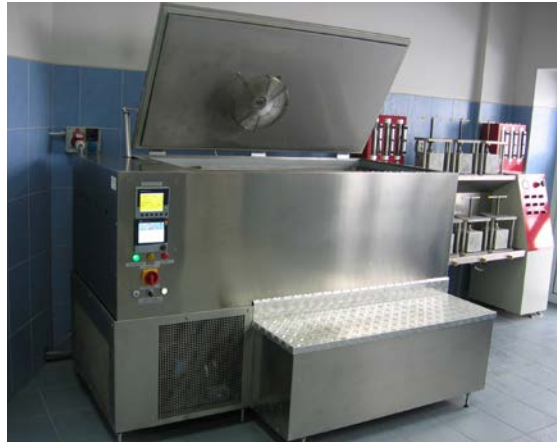
Fot. 5. Laboratorium zakładowe – komora do badania mrozoodporności betonu
