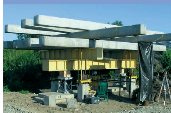
Próbne obciążenie statyczne pala na obiekcie M-1
